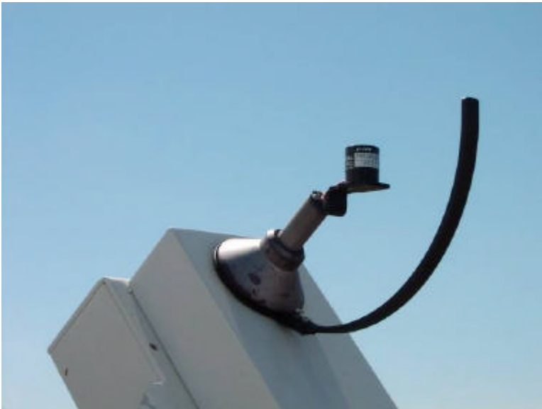
Global- und Diffusstrahlungsmessung mit einem Siliziumsensors mit rotierendem Schattenring Foto: DLR, Plataforma Solar de Almería
