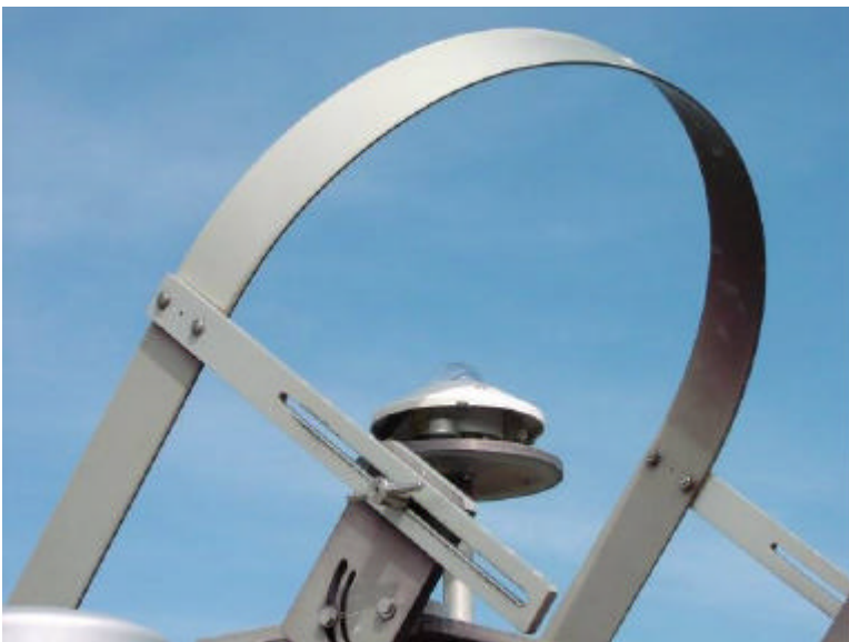
Diffusstrahlungsmessung mit einem Pyranometer mit festem Schattenring
