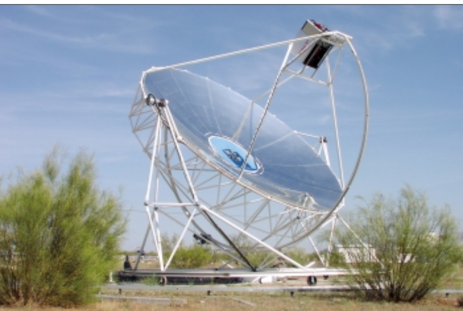
Abb. 6: Dish/Stirling-Versuchsanlage am europäischen Testzentrum Plataforma Solar de Almería in Spanien.
